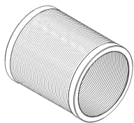
Manguera del Extractor
